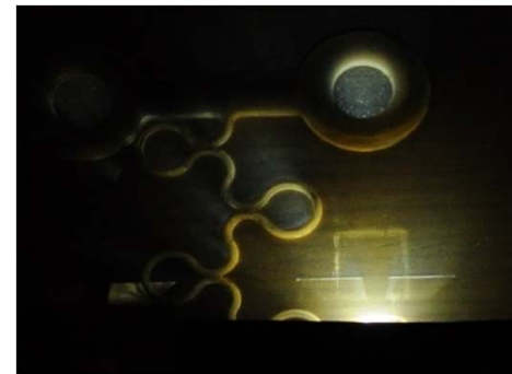
Vorwärtsrichtung und Auskopplung des LED-Lichtes (2D-Bauteil)
